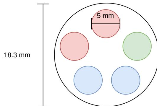
Illustration hur mycket utrymme i M25er-flexrör är kvar med 6 mm<sup>2</sup> solarkabel för två PV-strängar.
