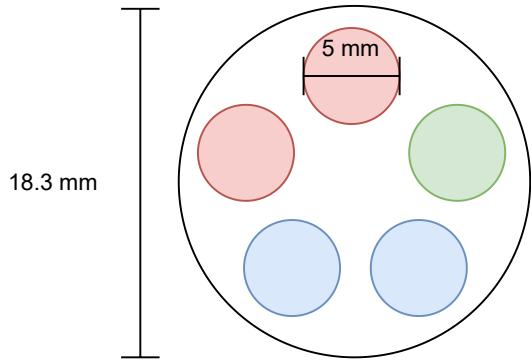
Illustration wie viel Platz im M25er-Wellrohr bleibt mit 6 mm<sup>2</sup> Solarkabel für zwei PV-Stränge.
