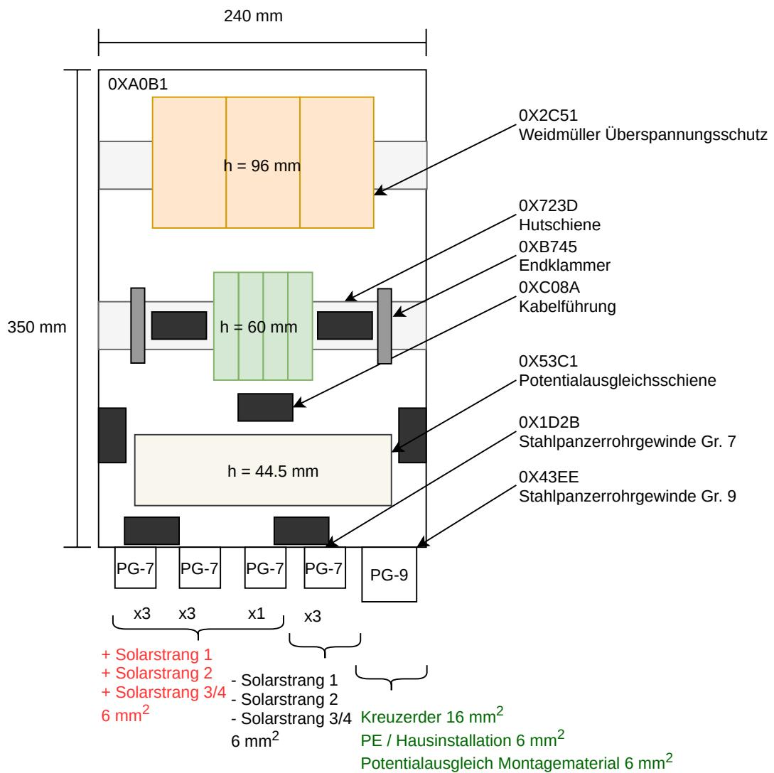
Montage Panzergewindevorschraubungen nur unten, um Wassereinbruch vorzubeugen.
